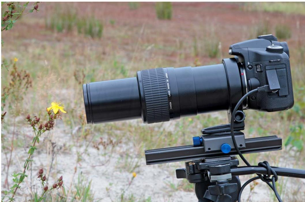
Abb. 5: Lupenobjektiv Canon MP-E bei ABM 5 : 1
