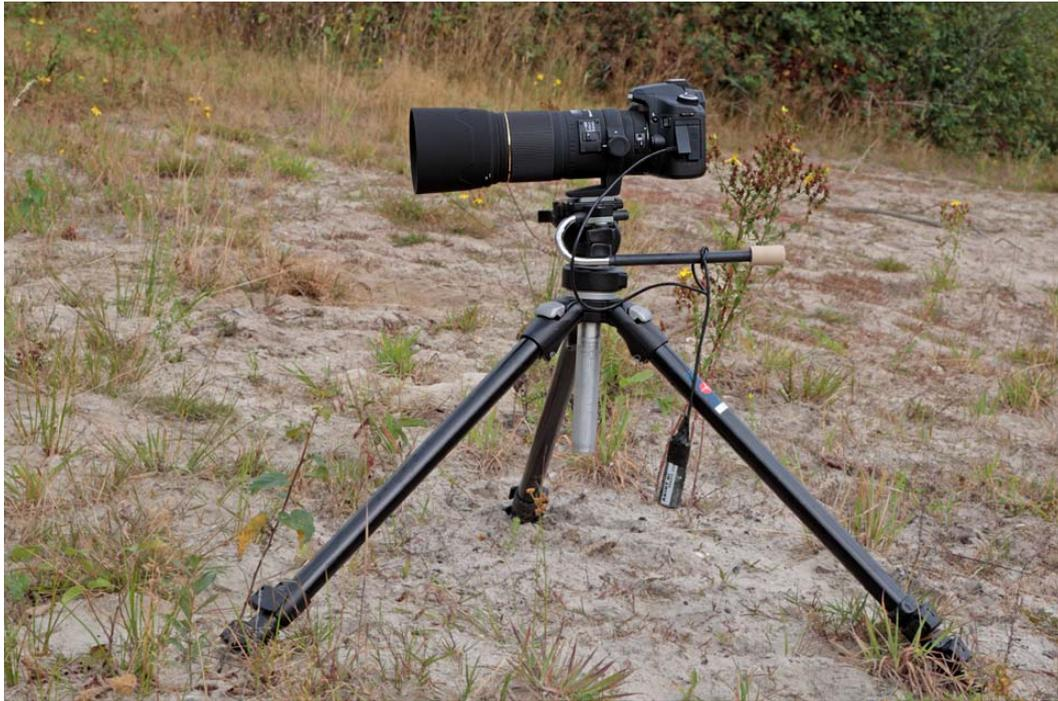
Abb. 6: Modifiziertes Bodenstativ
