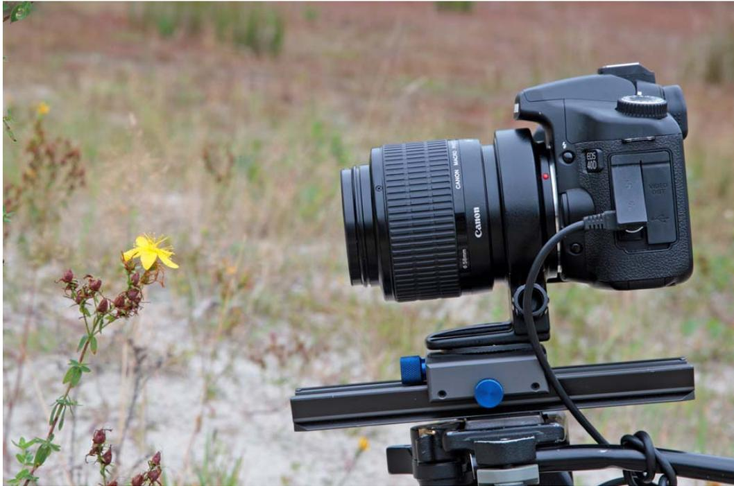
Abb. 4: Lupenobjektiv Canon MP-E bei ABM 1:1
